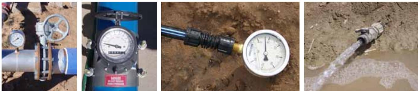
De izquierda a derecha: Manómetro de la línea principal; medidor de flujo; manómetro de la cinta; monitoreo del agua de lavado de la cinta.
