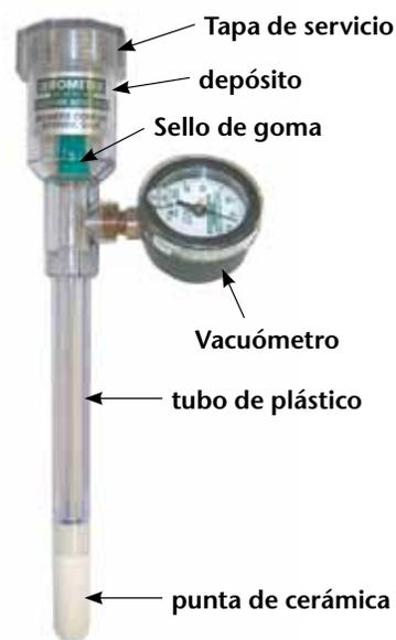
**Componentes del Tensiómetro**
